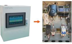
Предварительный монтаж и подключение PBAT-Gate, PBAT600Pro и HMI-Gate (дополнительно)
